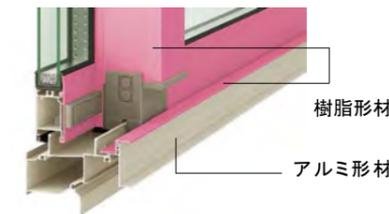
アルミと樹脂のハイブリッド構造で、断熱性能が大きく向上。
